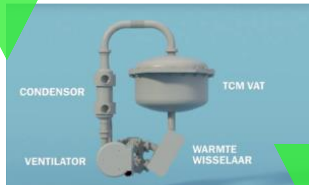
3 De warmtebatterij met K_2CO_3 (kaliumcarbonaat) als basismateriaal
