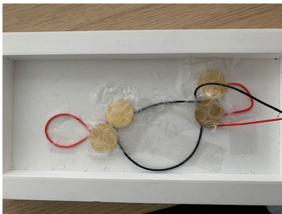
Afb 2 dit is onze ondergrond met de Piëzo elementen er op gemonteerd
